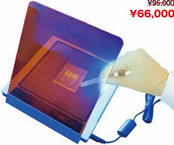
【使用例】ゲルを載せ、アンバーフィルター (標準付属品) を通して切り出し
