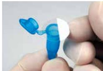
チューブによく貼り付けてから保護レイヤーをはがしチューブを包むように貼り付けます。
