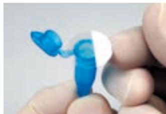
チューブによく貼り付けてから保護レイヤーをはがしチューブを包むように貼り付けます。
