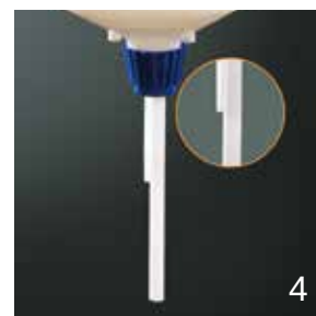
4. 細いチューブまで廃液の水面が届くと空気の抜け穴がふさがれ、オーバーフローを防ぐことができます
