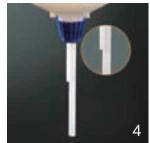
4. 細いチューブまで廃液の水面が届くと空気の抜け穴がふさがれ、オーバーフローを防ぐことができます
